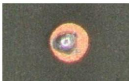
図6 微細溶解性確認 (φ0.2 mm/印刷体積率 8.7%)
