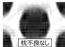
図9 X線撮像図 (0.4BGA/印刷体積率 14.5%)
