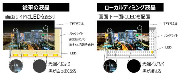
図 1 液晶モジュールの構造
