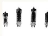
▲通信用傍熱型 MT管 (1955)(電子管)
