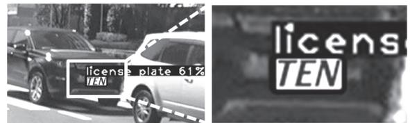
図 7 ナンバープレートの匿名化結果
