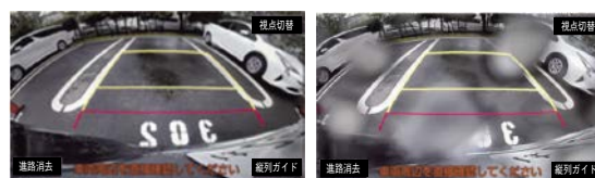
図1 水滴が付着したカメラの映像
