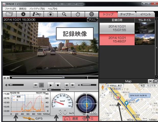
車速と車両 G 車速表示 車両 G 表示 自車位置表示の重ね合わせ
