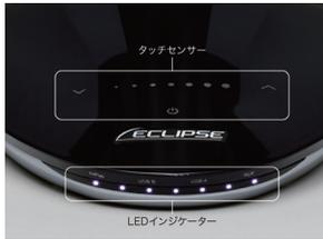
図2 タッチセンサとLEDインジケータ
