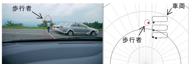
図9 車両周辺の歩行者検知試験（帯域幅=0.5GHz）
