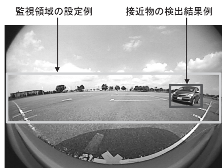
図6 監視領域設定と接近物検出結果の例
