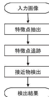
図5 接近物検知方式の処理の流れ
