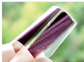
(a) 太陽電池 (2)
