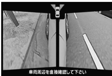
図6 幅寄せ時に利用する画面 Fig.6 Image Used for Parking on Verge of Road
