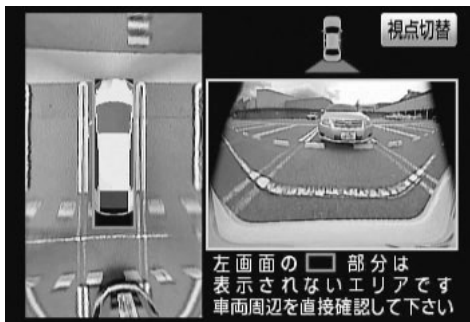
図5 駐車時に利用する画面 Fig.5 Image Used for Parking
