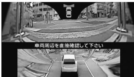
図4 見通しの悪い交差点で利用する画面 Fig.4 Image Used for Check at Intersection with Poor Visibility
