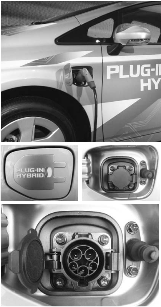
図8 車両側充電リッド
