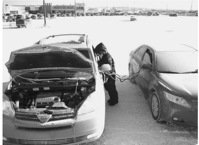
図4 RES寒冷地試験の様子 (-30℃のカナダにて)
