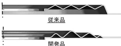
図13 ダンパ断面形状
