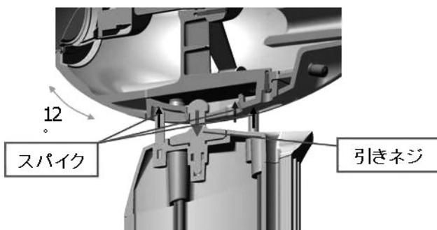
図17 TD712zMK2 角度調整機構
