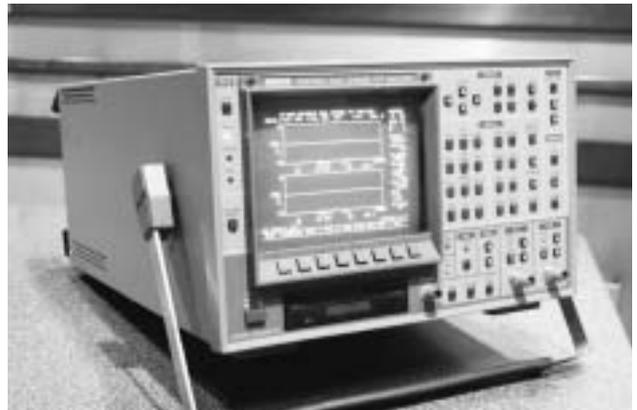
図2 ポータブルFFTアナライザの例(小野測器CF-360)
