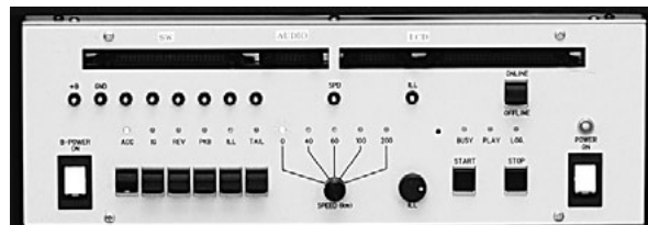
図-3 車載用ディスプレイ制御システム自動評価ツール
