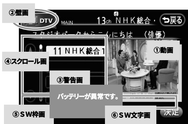
図-21 車載における表示例（6プレーン） Fig.21 Sample in-vehicle display (6-plane)
