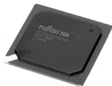
図-24 映像処理ASIC Fig.24 Image processing ASIC
