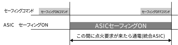
図-16 フル電子セーフィング制御タイミングチャート Fig.16 Control timing chart for fully electronic safing system
