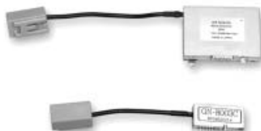
図-16 GPSレシーバ(上段: 従来品、下段: 本機)
