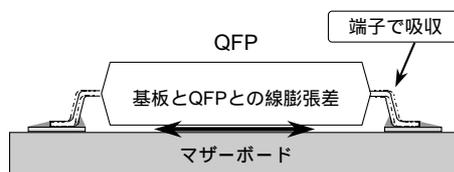
図-3 QFP実装での熱応力の影響
