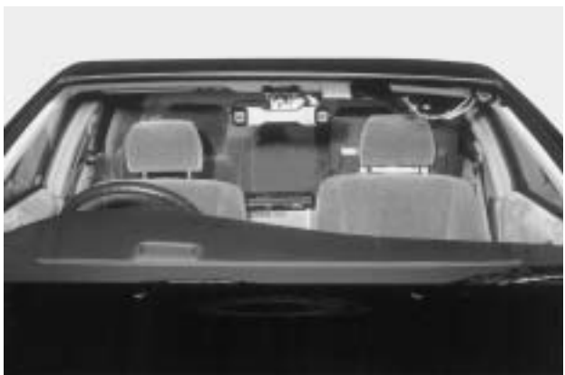
図-17 画像認識センサ取付け部 Fig.17 Attachment of image recognition sensor
