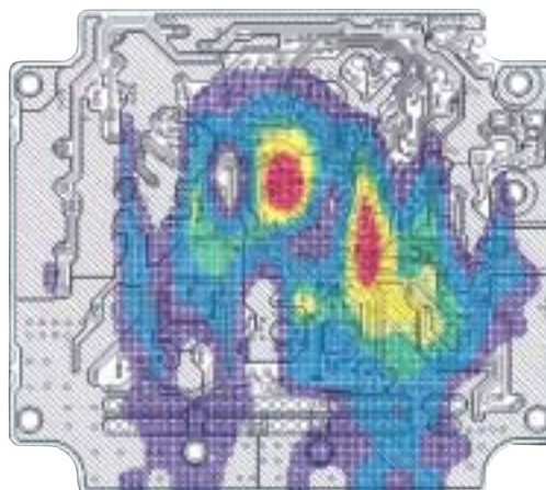
図-3 ノイズ可視化図とICADプリント基板図との画像合成例
