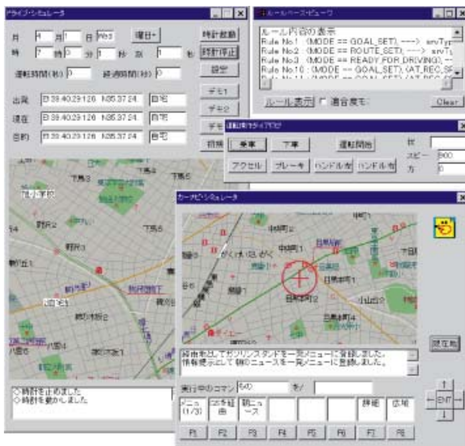
図-7 能動的カーナビプロトタイプシミュレータ
