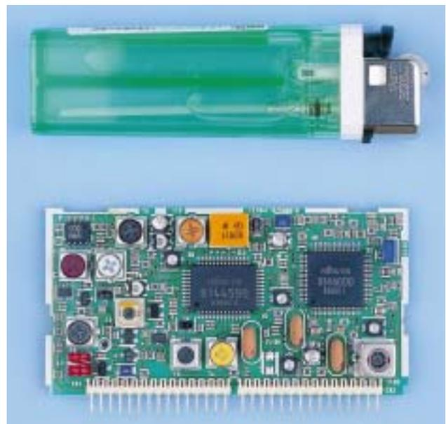
図-22 ICを搭載したチューナモジュール
