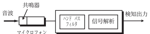
図-7 ガラス割れセンサーのシステム構成 Fig.7 System structure of Glass breakage Sensor
