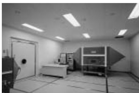
図-2 シールドルーム
