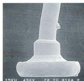
図-5 ベアチップ実装状態と接合部
