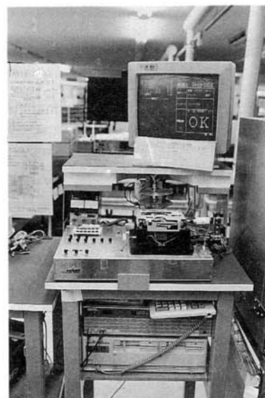
図-7 CDデッキ“DA-09”自動試験システム
