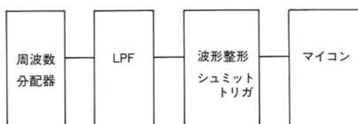
図-7 FTM40-3556AT無線装置におけるデコーダの構成 Fig.7 FTM40-3556AT decoder configuration
