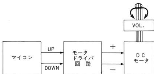
図-5 電動式ロータリーボリューム駆動方式
