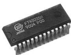
図-20 AMチューナIC (シュリンクパッケージ)
