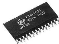
図-19 AMチューナIC (ミニフラットパッケージ) Fig. 19 AM tuner IC (miniature flat package)
