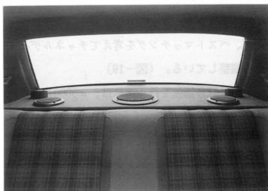
図-18 リアスピーカ取付写真 Fig. 18 Rear speaker installation
