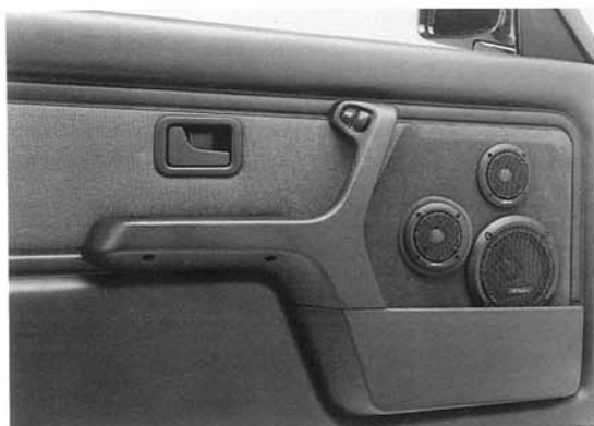
図-17 フロントスピーカ取付写真 Fig. 17 Front speaker installation
