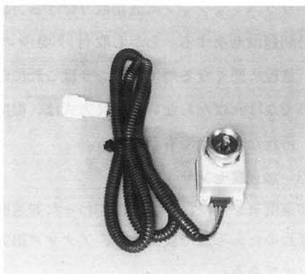
図-10 回転速センサの外観（車速センサ）
