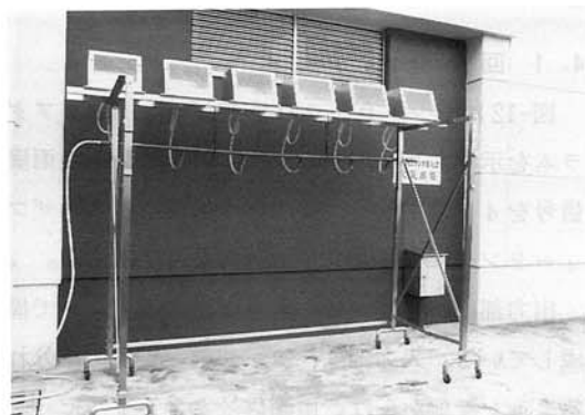
図-15 製作した降雨シミュレータ
