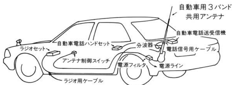
図-12 自動車用3バンド共用アンテナの実装例
