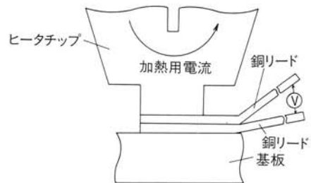
図-1 銅リード・銅リード間の電圧計測
