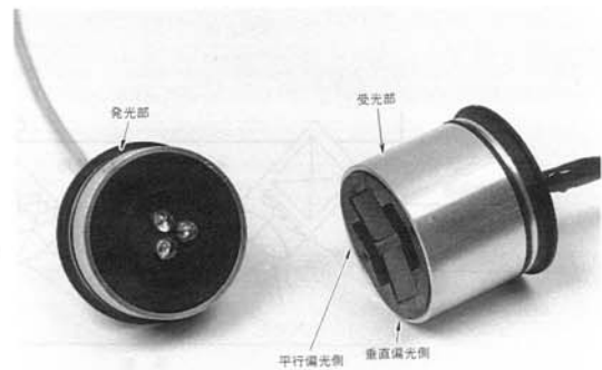
図-6 センサの内部構造
