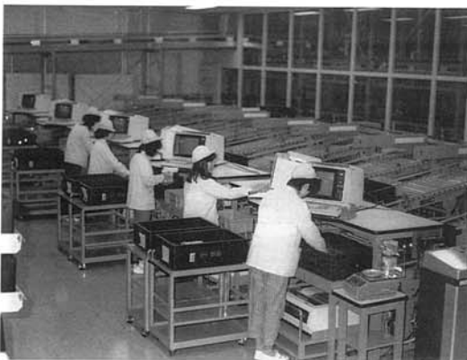
図-10 ピッキングステーション Fig. 10 Picking station.
