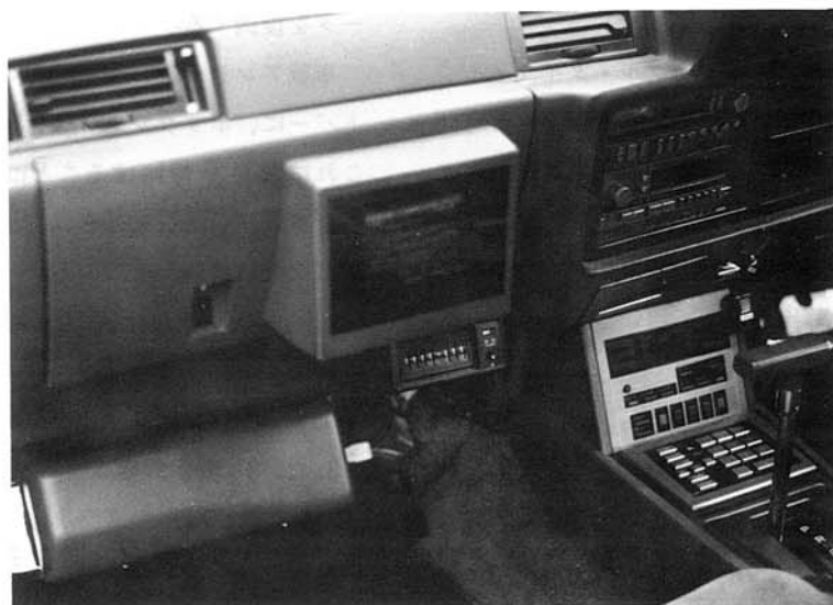
図-17 表示制御部、CRT、キーボード Fig. 17 Display controller, CRT, key board.
