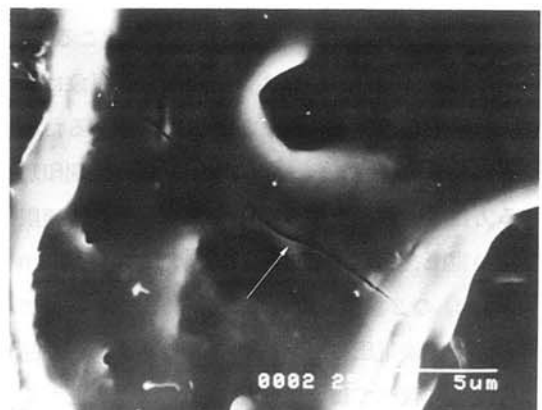
図-12 マイクロクラック発生の一例 (SEM) Fig. 12 Microcrack.
