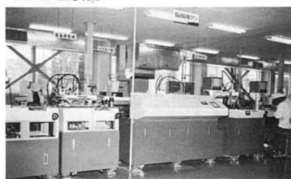
ハンダ印刷 → 部品搭載 → リフロー
