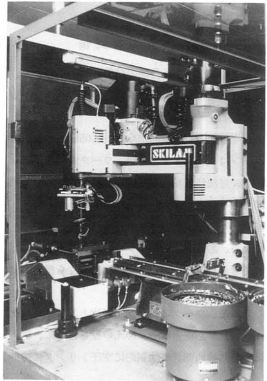
図-9 つまみ挿入ロボット
