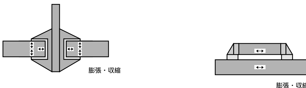
図-11 温度サイクル試験によるはんだへの応力方向 Fig.11 Direction of stress in solder caused testing
