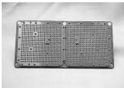
図-7 平面アンテナ構造 Fig.7 Configuration of planar antenna
