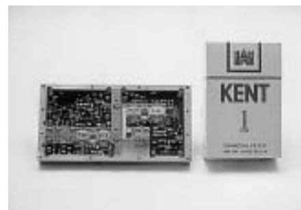
図-8 ミリ波ユニット Fig.8 Millimeter-Wave unit for radar sensor
