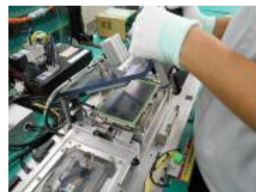
部品交換作業の様子
