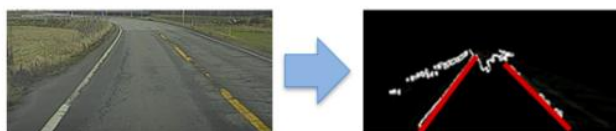
図2 実際に記録した映像のヒストグラム解析(車線検知)
