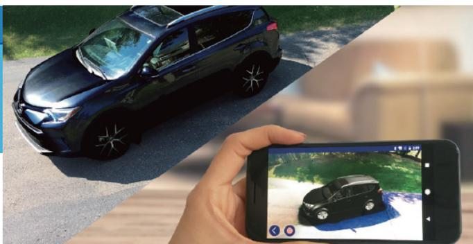
リモートマルチアングルビジョンでは、通信ユニットと衝撃感知ユニット、さらには侵入検知ユニットと組み合わせることで、盗難など車両が異常を検知すると自動でスマートフォンに通知し、離れた場所からでも自車の周囲の様子を確認することができます。
