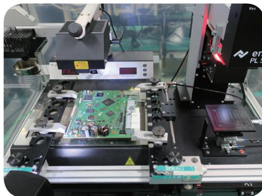
集中修理拠点に「高機能リワークシステム」を導入し、電子回路基板の安価な修理、廃棄量の削減を実現。
