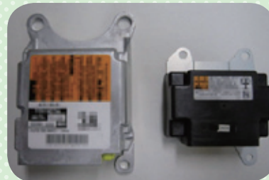
エアバッグECU (左：従来製品 右：開発製品)
