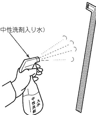
16 フィルムTVアンテナをマーキングに合わせてフロントガラス内側面に貼り付ける。
